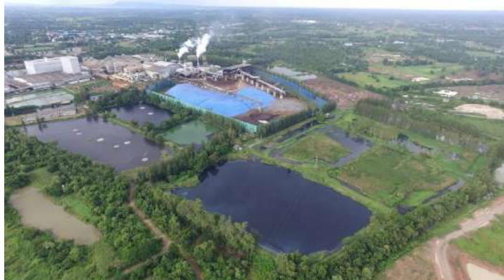
รูปที่ 2-31 ระบบบำบัดน้ำเสียของโครงการ ขนาด 1,800 ลูกบาศก์เมตร/วัน
